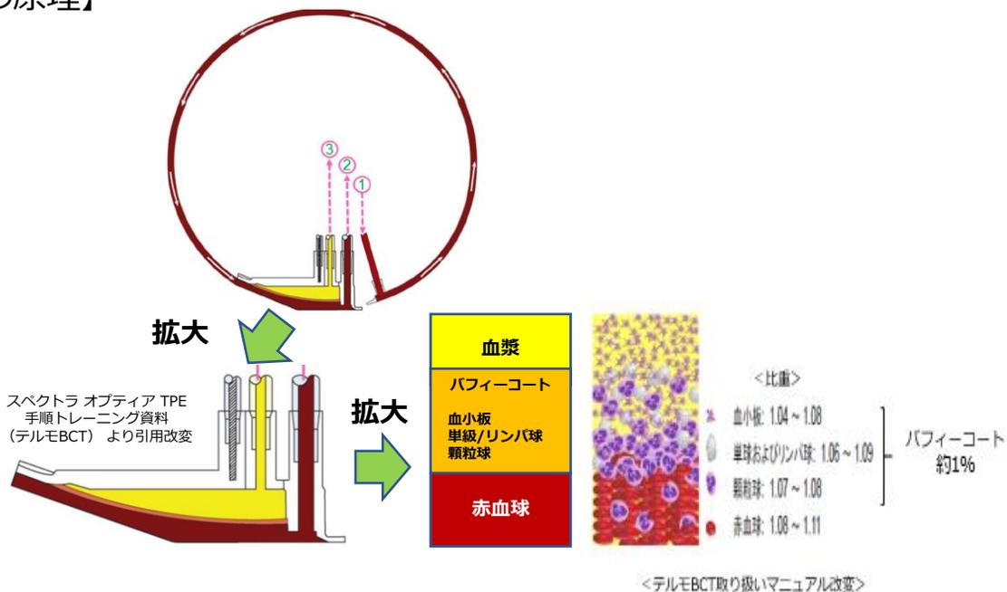
遠心分離は、各細胞の持つ比重の差を利用し、特定の遠心力をかけることにより血液を各成分に分離する方法です。比重の重い血球成分は遠心力を与えると外側（底）にたまり、比重の軽い血漿成分は内側（上）にいくことにより分離可能となります。
